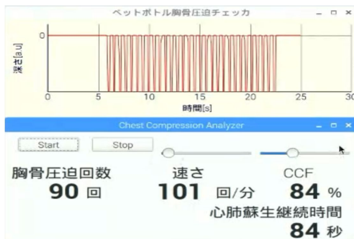
図 3. 胸骨圧迫評価システムの表示画面 胸骨圧迫の回数, 胸骨圧迫の速さ, CCF (胸骨圧迫比) 心肺蘇生の継続時間が可視化される。
