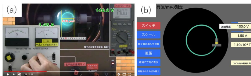
図2 (a)装置を用いた電子の比電荷実験 (b)電子の比電荷実験のシミュレーション
