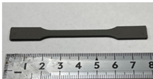
Fig,1 FFF 方式により造形した Ti 試験片
