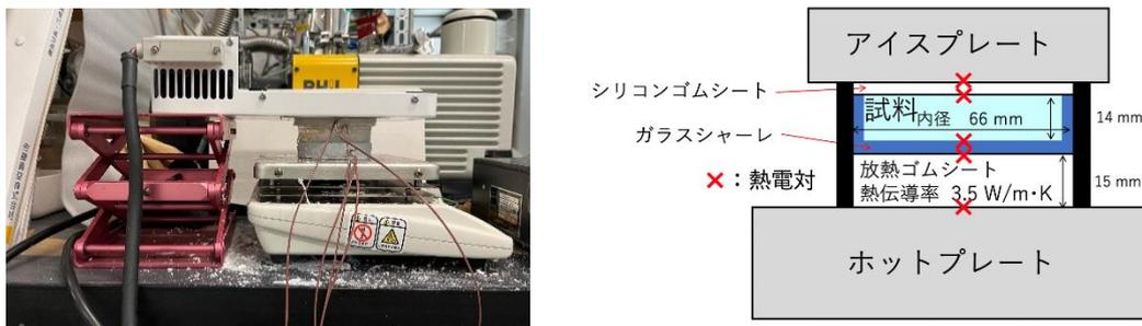
図 2 本研究で制作した熱伝導率測定装置の写真と概略図
