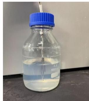
図 1 振盪ゲル試料と熱電対を入れた、温度変化測定用ガラス製ねじ口瓶の写真
