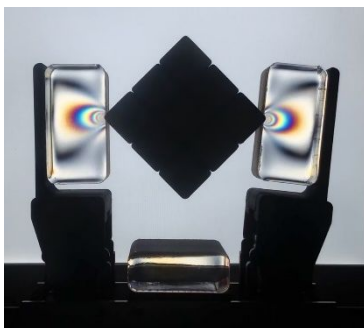
図3 光弾性ロボットハンド
