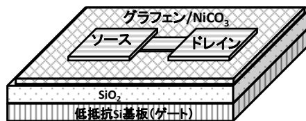
図3. グラフェン TFT の構造
