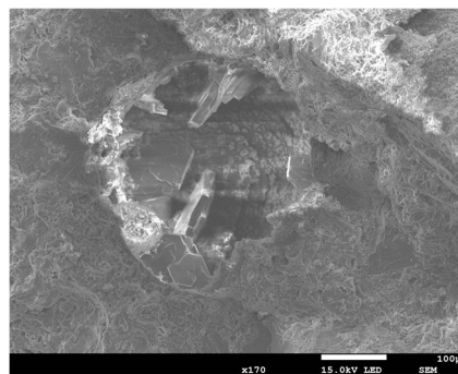
図-11 SAP 空隙中に析出した水酸化カルシウムの結晶
