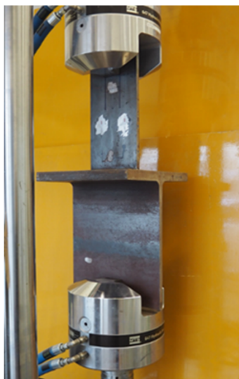
図3 疲労試験状況
