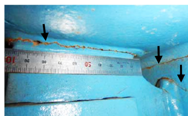
図 3 進展き裂の例(矢印部)
