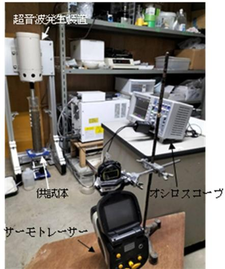
写真4 超音波照射実験と温度測定実験の様子
