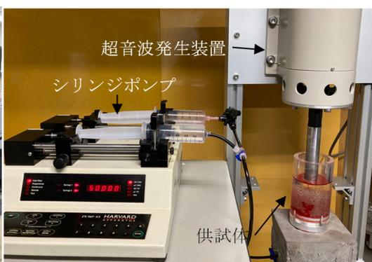
写真2 超音波照射と通水実験の様子様子
