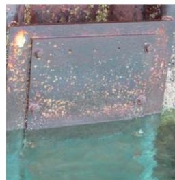
図7 現地暴露試験(炭素鋼板供試体)の様子(設置3年後)
