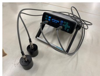
写真3 超音波伝播測定試験機
