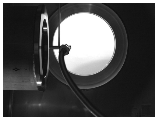
図 6: 表面粗さ模型を用いた希薄風洞計測写真
