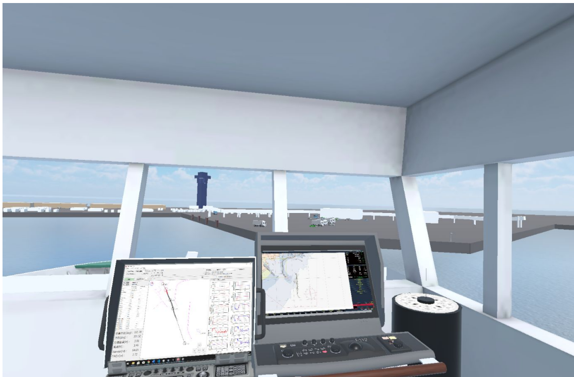
Fig.6 自動着棧システムが船橋内に表示された VR 空間
