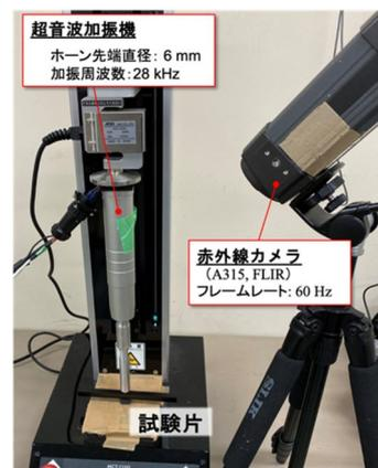
図1 超音波励起サーモグラフィ検査による実験の様子
