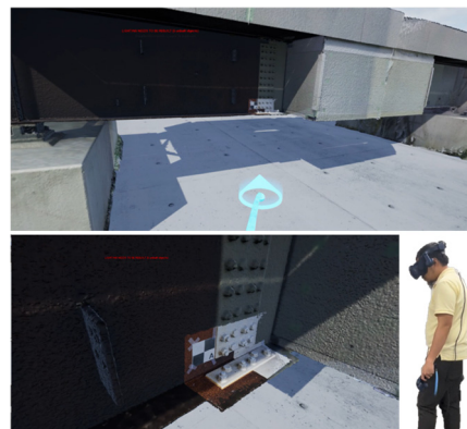
図9 点検シミュレータへの3次元橋梁モデルの適用状況
