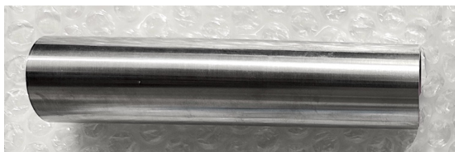
図 1 熱条件を最適化した熱間鍛造手法により製造した TiZrV 合金ターゲット
