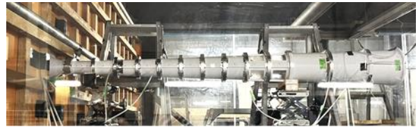
図 1 5 高アスペクト比ディフューザ( AS = 60 )
