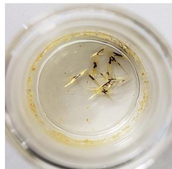
図 10 NiTbNi を種結晶として添加して得られた ZnTbZn 結晶 (黒色の結晶が NiTbNi、黄色の結晶が ZnTbZn)
