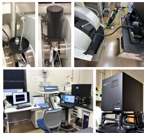
図4. 開発したCL-ST-ESR測定装置. 左上から、ESR試料部、ESR試料遮光カバー、ESRとCLを光ファイバー接続部、装置全体、CL検出部。
