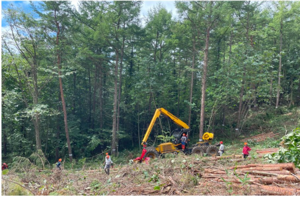
左図：CTL システムによる主伐作業の様子
