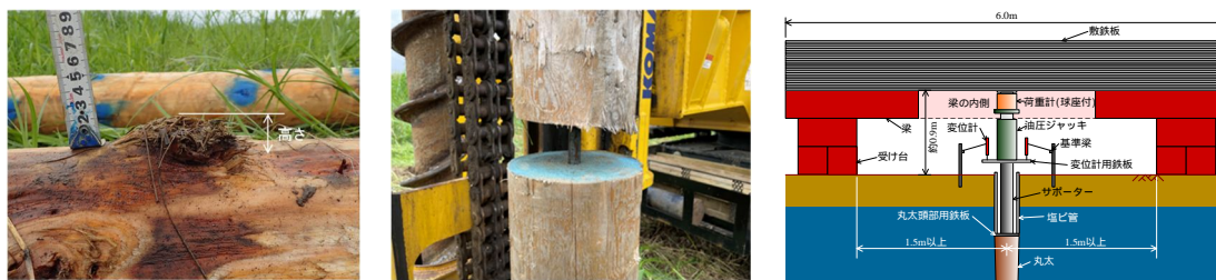
(a) 丸太の節 (b) 継ぎの状況 (c) 押込み試験の概要
