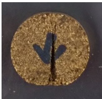
図 6. 熱圧成型体の破壊性状
