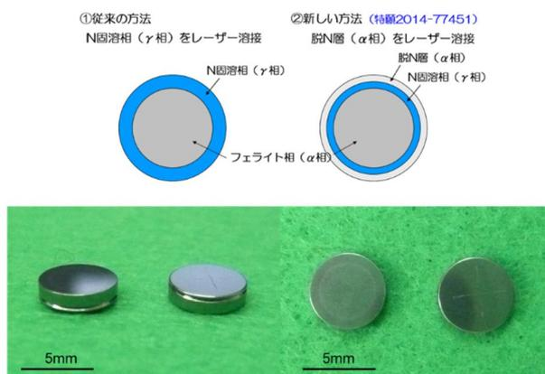
図7 試作N固溶磁石構造体(3層構造)
