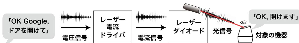
図1 ライトコマンド: レーザーを用いて音声コマンドを挿入する攻撃
