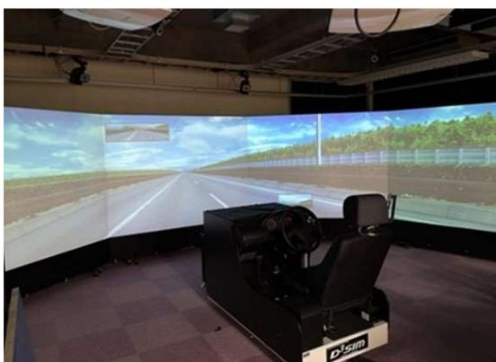
三菱プレジジョン社開発のドライビングシミュレータ・プラットフォーム (D3sim)
