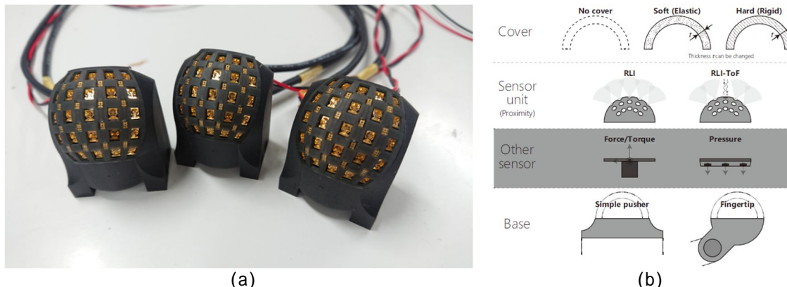
図1 開発した近接覚センサ (a: 近接覚センサ外観, b: モジュール型設計)
