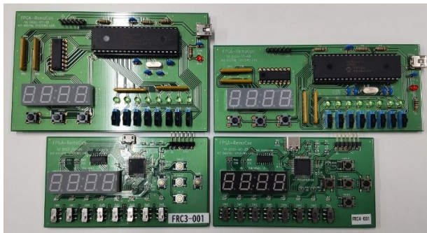
図 2: 試作したコントローラボード (第 1 版 ~ 第 4 版)。
