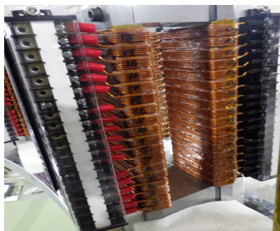
図1 VFFA用マルチコイル型電磁石
