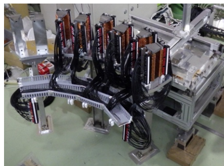
図2 VFFA集束系と磁場測定装置
