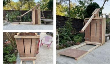
写真 1：制作した手動式ベラー
