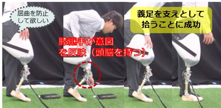
手法によって切断者の動作意図を反映させる必要がある。さらに、本研究で開発するサイボーグ義足は健足の機能を補うという点でこれまでに開発してきたロボット義足と異なり、下肢の運動機能や切断者固有の特性分析が不可欠である。長年研究にご協力いただいている下肢切断者の方々を対象に、筋電位計測機や3次元動作解析装置等を用いて切断者の運動機能を数理モデル化し、新たなサイボーグ義足を設計する。
