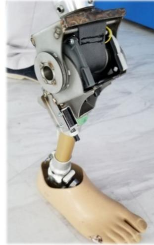
そして、転倒の回避に必要な膝継手の挙動を明らかにし、転倒の危険性の有無等の切断者の状態に応じた膝継手の制御を可能とするために、Finite state machine に基づくサイボーグ義足のための新しい転倒回避支援システムを提案した。最終的には、提案システムを実装したサイボーグ義足を用いて、大腿切断者による歩行中の膝折れを模擬する実験を実施し、本提案システムの有効性を示した。本サイボーグ義足は大腿切断者に対する安全性を確保することで、大腿切断者の義足歩行獲得率の向上が期待される。
