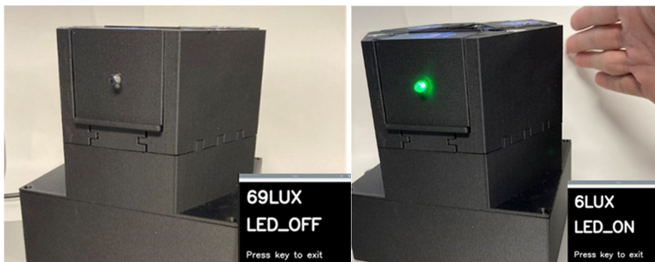
図5 照度センサーとLEDを組み合わせたサンプルプログラムの実行結果
