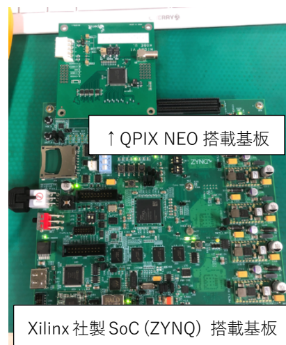
図 3: QPIX NEO 性能評価のために構築した DAQ システム。
