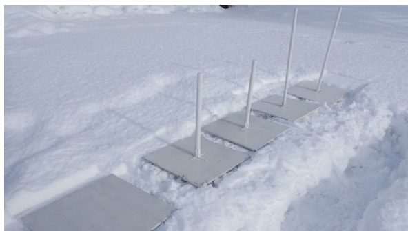
図2 降雪板を用いた新積雪の観測の様子。
