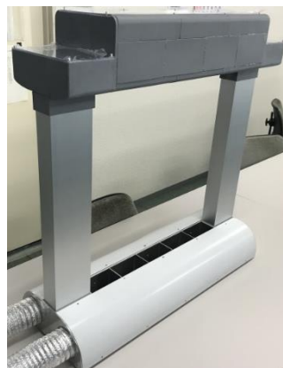
図3 エアカーテン発生装置の試作機
