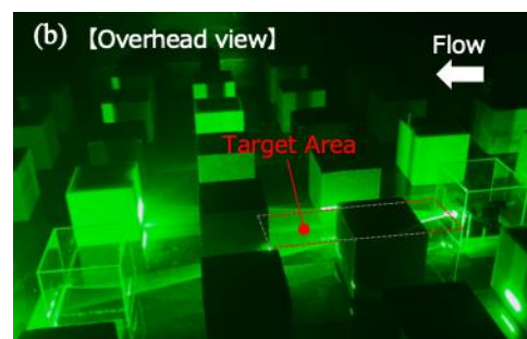
図 3. 単純建物模型群を対象とした風洞実験 (PIV 計測) の一例 2)
