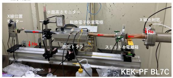
渡辺巌先生が開発し、申請者らが展開してきた全反射 XAFS 測定(今井ら、日本化学会論文誌、91巻、p1487、2018 年)を軽元素対カチオンに適用するため、改良を行った。軽元素の K 吸収端をプローブとした XAFS は、X 線のエネルギーがテンダーX 線以下であり、大気中では X 線の減衰により測定が困難であるため、X 線の光路を全て He 雰囲気においた。実験対象として、オクチルベンゼンスルホン酸ナトリウム (SOBS) と塩化カルシウム (CaCl2) の混合水溶液を採用し、表面吸着膜での  $Ca^{2+}$ の水和構造および溶液ミセル表面の Ca2+の水和構造を、それぞれ Ca の K 吸収端をプローブとした全反射 XAFS 測定および蛍光 XAFS 測定 (SAGA-LS BL06 にて実施) と、それらの EXAFS 解析より調べた。
