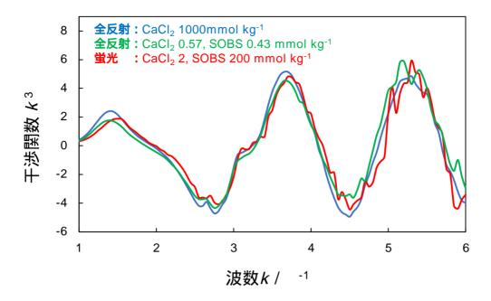
全反射および蛍光 XAFS から得られた スペクトルを上図に示す。Ca²+が水溶液表面で完全水和をする条件(青)、Ca²+がオクチルベンゼンスルホン酸吸着膜のスルホ基と相互作用をする条件液(緑)、Ca²+が溶液内のミセル表面のスルホ基と相互作用をする条件(赤)でスペクトルの形状に有意な差は見られなかった。このことから、平面の吸着膜でも球面のミセル表面でも、Ca²+が溶液中と同様に完全水和をしていることが示唆された。これは Collins 則から予想される描像と同様である。今後の EXAFS 解析により水和数や配位距離などの構造パラメーターの定量も期待される。
