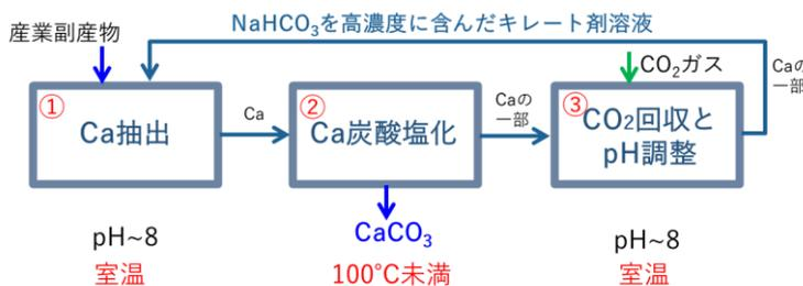
図4. 温度スイング式加速鉱物化プロセス
