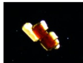
図3. \text{Fe}_{\text{cdpp}} シード結晶から面選択的に \text{Co}_{\text{adpp}} が結晶成長した結果得られた構造体のPOM像。
