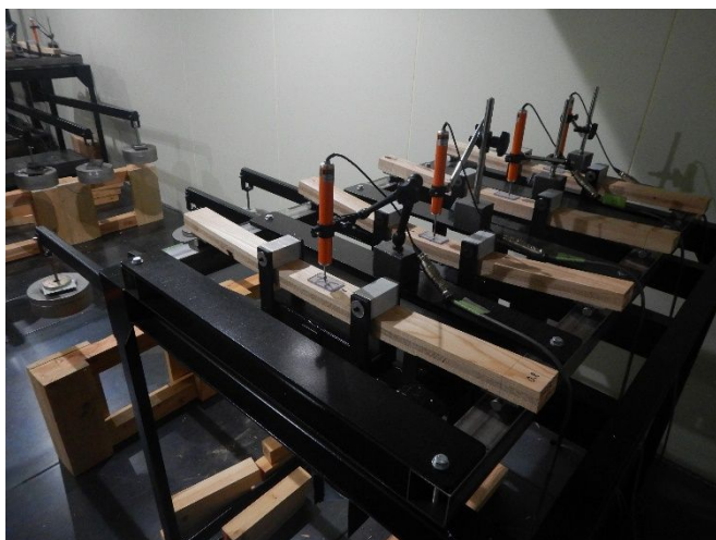
写真1 長期曲げ試験の様子
