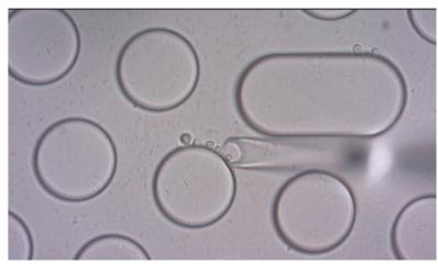
チップに捕捉した細胞のマイクロマニピュレーターによる回収(富山県産業技術研究開発センター大永先生提供)
