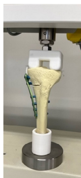
図 4 負荷試験装置
