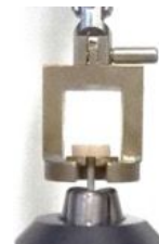
図2. 引き抜き試験
