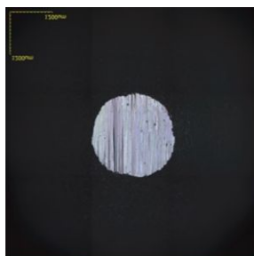
図3 試験後の摩耗痕(左:上部試料、右:下部試料)
