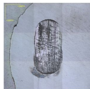
図3 試験後の摩耗痕(左:上部試料、右:下部試料)
