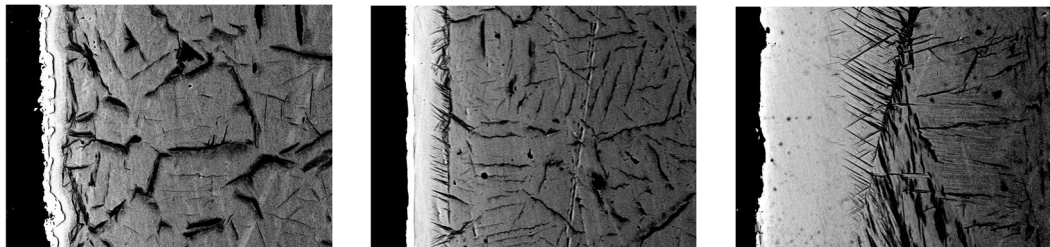
図 1 チタン表層の拡散合金層 (左より 700 °C -10 分、800 °C -10 分、900 °C -10 分)
