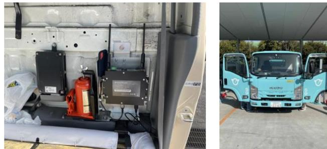
図 3 ごみ排出量センシング装置の取り付け作業
