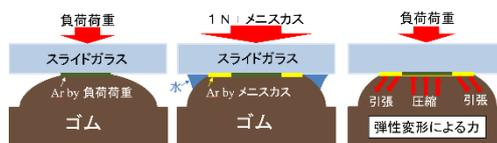
図 16 実験中の真実接触面積の変化
