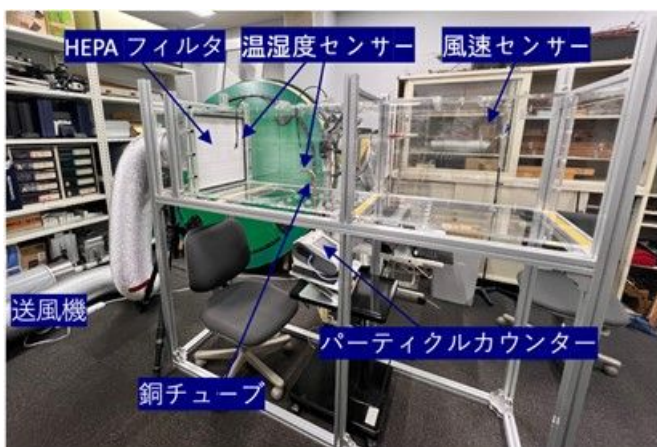
図 パーティクルカウンターによるエアロゾル計測装置
