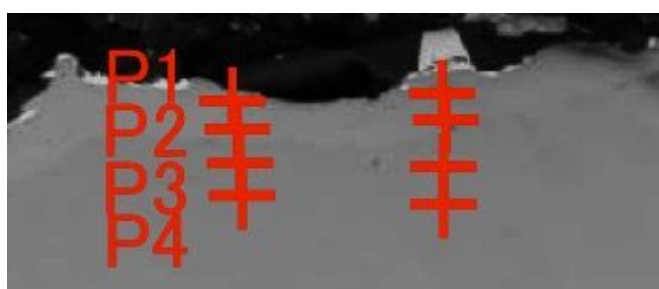
Fig. 7 EPMA による 900 °C 試料の断面点分析
