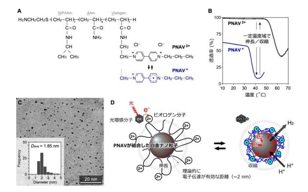
**図:能動電子輸送を指向した高分子・触媒ナノ粒子の精密設計**. **A.** 三元系高分子 Poly(NIPAAm-co-AAm-co-Viologen) (PNAV). 伸長 / 収縮の相転移を起こす部位 N, ナノ粒子と結合する部位 A, および電子を授受する部位 V で構成. **B.** PNAV の温度に対する透過率。部位 V の価数により、PNAV<sup>2+/+</sup> の相転移温度に大きな差を持つ。**C.** PNAV が結合した白金ナノ粒子の TEM 画像. **D.** PNAV-Pt ナノ粒子における電子輸送。光捕集分子から電子を得た PNAV (PNAV<sup>+</sup>) は収縮し、白金ナノ粒子に近づき電子を渡す。その際、PNAV<sup>2+</sup>となると伸長してナノ粒子表面から離れる。この能動的な電子の授受を繰り返す。
