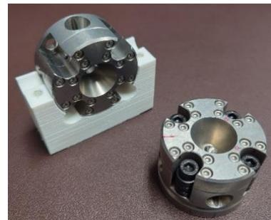
図 10 ダイヤモンドアンビルセル
